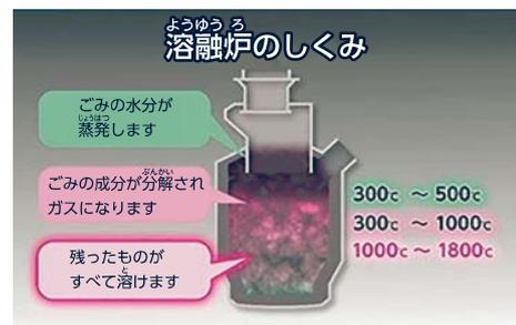
名古屋市の焼却工場の中には、可燃ごみや他の焼却工場で可燃ごみを燃やした後に残った灰、破碎工場で砕いたごみを高温で溶かすことのできる工場もあります。溶融炉の中で最も温度が高い1000℃～1800℃の層で、ごみや灰をすべて溶かし、それを水で冷やすと、「スラグ」という砂のようなものと「メタル」という金属になり、スラグは道路のアスファルト舗装の材料など、メタルは建設機械の重りなどとして、それぞれリサイクルしています。
